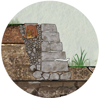
Trockenmauern und Hohlräume
