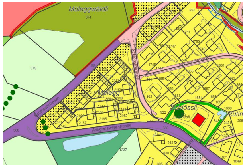
Unterscheidung der Verkehrszone und den Verkehrsflächen. Zur Veranschaulichung wurden in diesem Ausschnitt die Verkehrszonen pink und die Verkehrsflächen violett eingefärbt. Die Farbgebung entspricht nicht derjenigen im Zonenplan, in welchem die Verkehrszonen hellgrau und die Verkehrsflächen hellbeige dargestellt sind.
