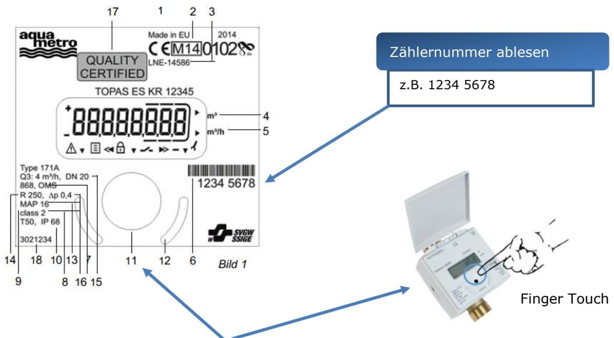
2. Mit dem optischen Taster (Bild) auf der Front können die einzelnen Parameter abgefragt werden.
